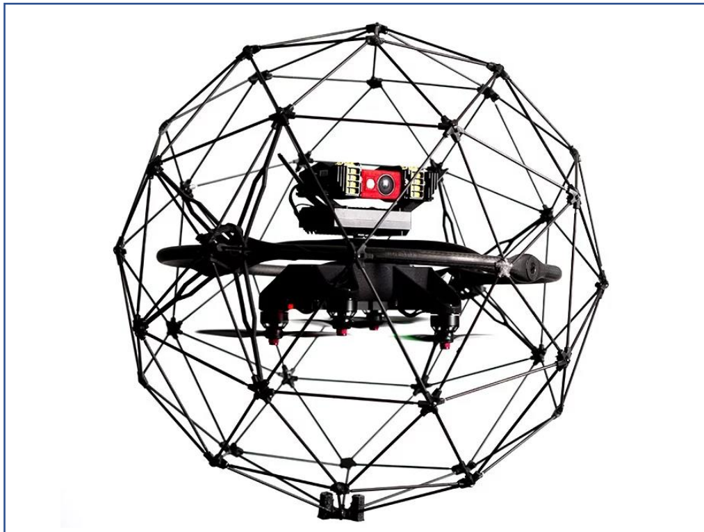
Figura 8 – Proteções contra colisões em drones (RPA)
